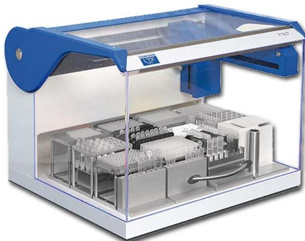
PIRO Pipettierroboter mit unterschiedlichen Racks und Adaptern
