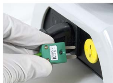
Anschluss der externen Sonde, Rückseite MSH-300i
