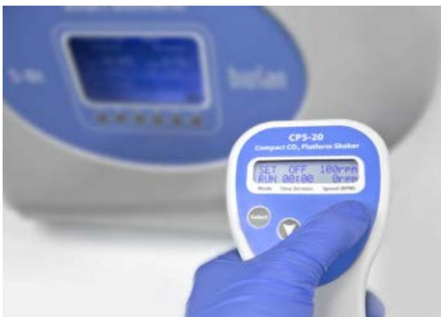
Die Fernbedienung sorgt für eine störungsfreie Inkubatorumgebung während des laufenden Experiments. Die Fernbedienung ist für den Betrieb in Kühlräumen, Inkubatoren (ausgenommen CO<sub>2</sub>-Brutschränke) und geschlossenen Laborräumen bei einer Umgebungstemperatur von +4°C bis +40°C in nicht kondensierender Atmosphäre und einer relativen Luftfeuchtigkeit bis zu 80% ausgelegt.
